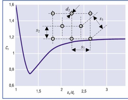
**Fig. 7** Correction coefficient  $C_2$
